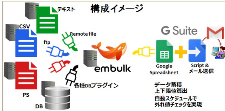
embulk : 入出力・フィルタプラグインを活用し、異形式のデータを自動収集ならびに統一レイアウトへ変換し、G Suite の Spreadsheet に出力
